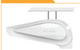
Fixation libre écrou/tige filetée M8 en montage horizontal
