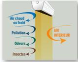
Une lame d'air pour isoler les locaux ouvrant sur l'extérieur.
